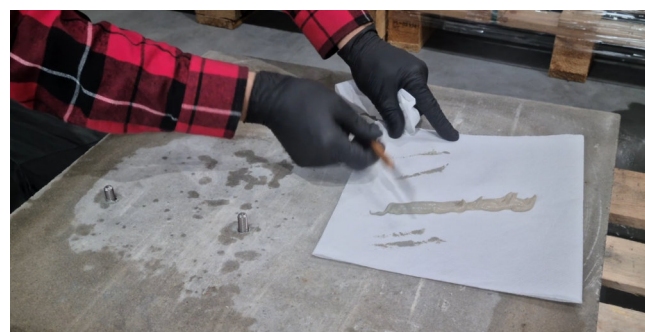
5. Sjekk hardigheten på testmassen på arket fra steg 1. Ca 20 min - se instruksjoner i pakningsvedlegg
