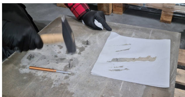
5. Sjekk hardigheten på testmassen på arket fra steg 1. Ca 20 min - se instruksjoner i pakningsvedlegg
